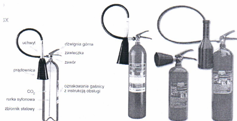
Rysunek 2 Gaśnice śniegowe widok i przekrój
